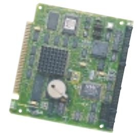
Микроконтроллеры серии 6000 работают в температурном диапазоне –40...+85°C, выдерживают удары до 10g и вибрацию до 2g. Все платы оборудованы сторожевым таймером.
