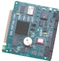
**Преобразователь интерфейсов RS-232 в RS-422/485 с гальванической развязкой**
